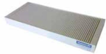
Aus gesundheitlichen Gründen [Allergien] kann an der Zuluftseite auch ein ePM1-Kassettenfilter [Pollenfilter] verwendet werden. Dieser Filter hält kleinere Partikel auf und sorgt für mehr Komfort, wenn Sie unter einer Pollenallergie leiden. Da diese Filter engere Öffnungen haben, steigt der Widerstand an diesen Filtern, was die Funktionsweise des Systems beeinflussen kann.
